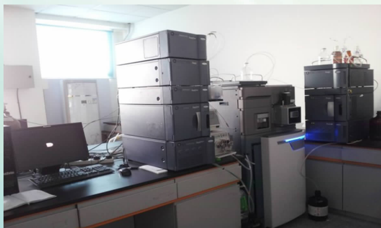
中医方证代谢组学研究中心所配备的 Waters ACQUITY UPLC 与 SYNAPT G2 - Si HDMS 液质联用系统
